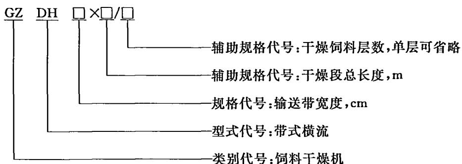
示例: 干燥饲料层为2层、输送带宽度为200 cm、干燥段总长度为18 m的带式横流饲料干燥机表示为GZDH200×18/2。
