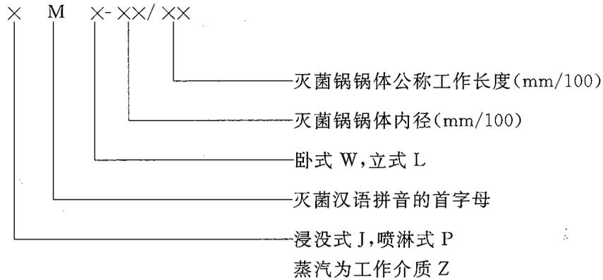
示例:蒸汽为工作介质的卧式灭菌装置,灭菌锅公称内径为 1 200 mm,灭菌锅体公称工作长度为 2 400 mm 的,表示为 ZMW-12/24。
